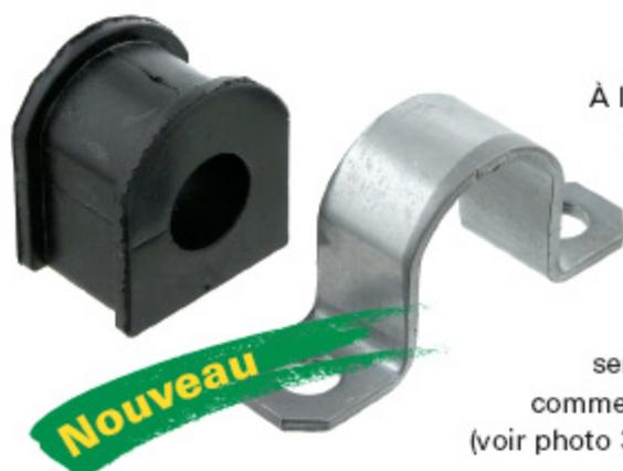
À la suite d'une modification apportée par le constructeur dans la fabrication du support des stabilisateurs avant, des problèmes sont survenus lors du montage de ces supports de stabilisateurs (febi 21855). En effet, la forme auparavant semi-circulaire est dorénavant droite, comme la pièce d'origine (voir photo 3 de la coupe du support).
