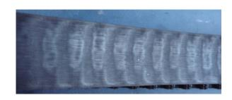
En effet, la courroie glisse sur les galets (d'où une usure constatée sur le dos). Le fonctionnement est alors bruyant, car la patte métallique du galet tendeur vient en contact avec la butée inférieure.
