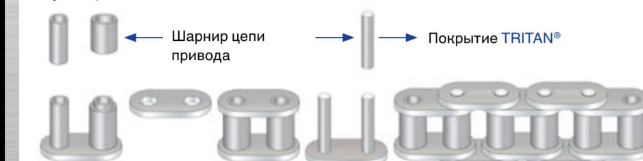
**(RU)** Цепи привода (втулочные и роликовые), состоят из внутренних и внешних звеньев. В качестве рабочих поверхностей шарнира используются сопряженные части валика и втулки. Снижение качества масла вследствие старения и действия агрессивных смесей масла, углерода и топлива, заметно усиливает износ шарнира (особенно в турбированных двигателях прямого впрыска), что ведет к вытягиванию цепи.
