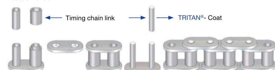
**(SR)** Lanac razvoda, konstruisani kao valjkasti ili sa rolerom, sastoji se od naslaganih unutrašnjih i spoljašnjih linkova samog lanca. U ovom slučaju pinovi i roleri formiraju zajedničku celinu. Kako kvalitet ulja slab, uzrokovani starenjem i agresivnim ulje, mešanjem ugljenika i goriva, habanje zglobova lanca je sve primetnije, posebno kod turbo-punjениh motora sa direktnim ubrzgavanjem, što na kraju rezultira izduženjem lanca.
