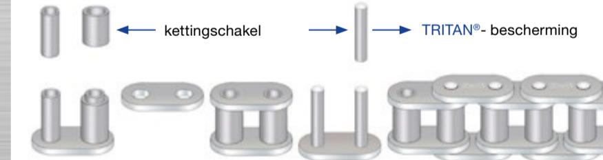
**NL** Distributiekettingen, uitgevoerd als bussen- of rollenketting, zijn opgebouwd uit een aaneenschakeling van binnens- en buiten-kettingschakels. De pennen en bussen vormen het gewrichtsoppervlak.
