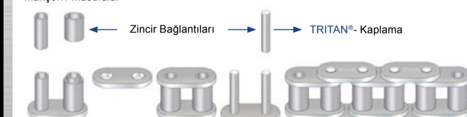
**(TR)** Burçlu veya makarali olarak dizayn edilen eksantirik zincirler, iç ve dış bağlantı noktalarına sahiptir. Bu nedenle pimler ve masuralar üzerinde bir ek yüzey alanı oluşur. Yağ kalitesinin azalmasıyla beraber zincir üzerinde bir yıprama meydana gelir, yağ, karbon ve yakıt karışımı bağlantı noktalarında aşınmalara neden olur. Özellikle turboşarj direk enjeksiyonlu motorlarla zincirde bir esnemeye neden olurlar.
