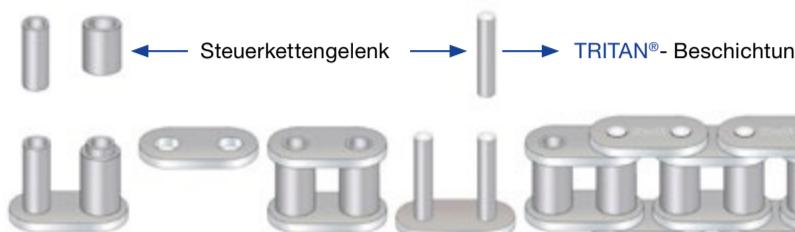
**DE** Steuerketten, ausgeführt als Hülsenketten oder Rollenketten, bestehen aus einer Anordnung von inneren und äußeren Kettengliedern. Die Gelenkflächen bilden dabei Bolzen und Hülsen. Mit abnehmender Ölqualität, verursacht durch Alterung und aggressiven Öl-Kohlenstoff-Kraftstoffmischungen, macht sich der Verschleiß in diesem Gelenk vor allem bei turbo-direkteinspritzenden Motoren bemerkbar, was zur Längung der Kette führt.
