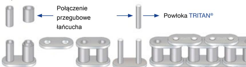
**(PL)** Różne wersje łańcuchów rozrządu – tulejkowe lub rolkowe – zbudowane są z połączonych ze sobą ogniw wewnętrznych i zewnętrznych. Sworznie i tulejki tworzą połączenia przegubowe. Wynikające ze starzenia pogorszenie parametrów smarowania oleju silnikowego oraz agresywne działanie oleju, paliwa i sadzy przyspiesza zużycie przegubów łańcucha. Zjawisko to jest szczególnie nasilone w turbodoładowanych silnikach z wtryskiem bezpośrednim, a objawem jest wydłużenie łańcucha rozrządu.
