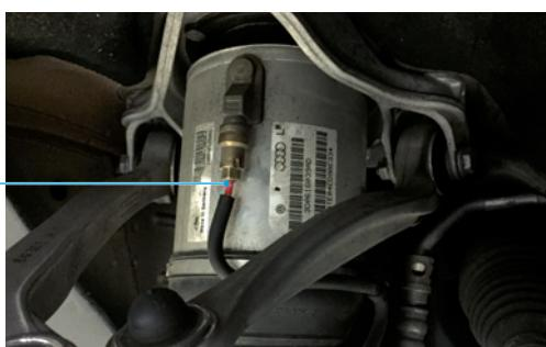
Restdruckhalteventil beim Lösen mit geeignetem Werkzeug gegenhalten.
