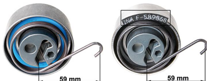
Photo 2 : réf. 531 0819 10 - A gauche, l'ancienne version, à droite, la nouvelle version
