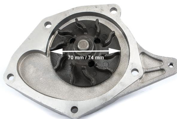
Mesurer le diamètre de la turbine après avoir déposé la pompe à eau.
