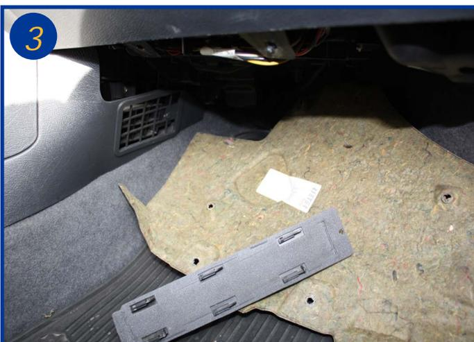
Il n'est pas nécessaire de retirer totalement le carter souple sous la boîte à gants.
