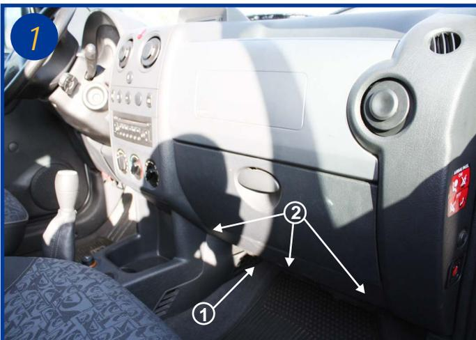
L'élément filtrant est situé dans l'habitacle du véhicule côté passager sous la boîte à gants (1).
