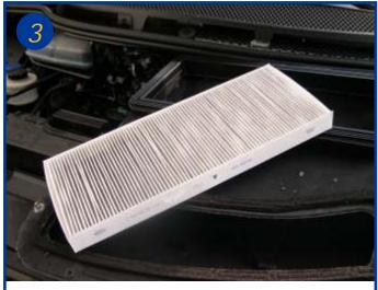
Extraire l'élément filtrant usagé -Le remontage s'effectue dans l'ordre inverse du démontage
