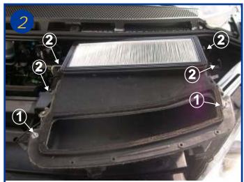
Dévisser les deux vis d'un quart de tour situées à gauche et à droite du boitier (voir repére 1). Dégrafer les quatre sauterelles à gauche et à droite (voir repère 2) Retirer le boitier en le tirant vers l'avant
