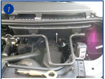
L'élément filtrant est situé sous le capot moteur coté conducteur (voir flèche)
