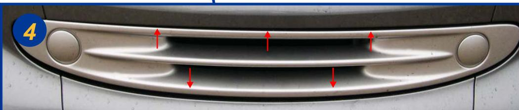
Dégrafer la calandre en faisant appui délicatement avec un tournevis plat aux endroits indiqués sur la photo jointe (flèches en rouge). Extraire celle-ci totalement.
