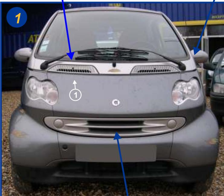
Le filtre d'habitacle est situé à l'avant du véhicule derrière la grille de ventilation coté passager (1).
