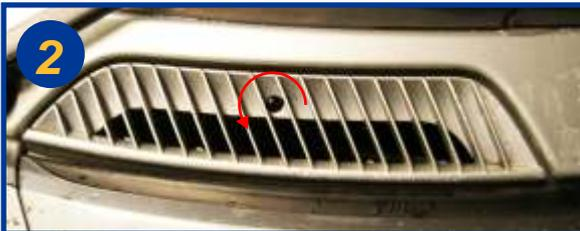
A l'aide de la clé de contact ou d'un tournevis plat, retirer la grille de ventilation en tournant d'un quart de tour à l'endroit indiqué.
