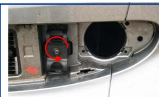
Vous pouvez désormais dissocier la face avant de la voiture en débranchant préalablement les répéteurs de clignotants à l'intérieur en tournant d'1/4 de tour la douille de l'ampoule.
