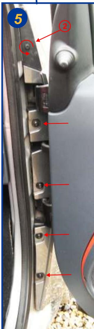
Retirer les clips plastique (2) à l'aide d'un tournevis à empreinte torx T30, répéter l'opération de l'autre coté.
