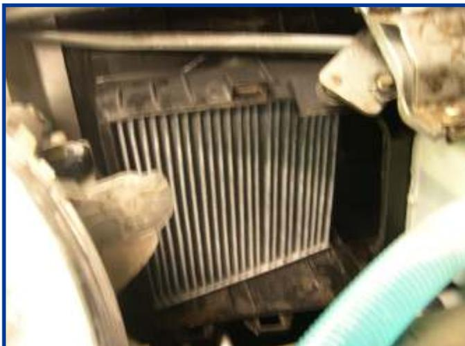
Extraire l'élément filtrant usagé et procéder à son remplacement après avoir au préalable nettoyer l'intérieur du boîtier filtrant. Le remontage de l'ensemble s'effectue dans l'ordre inverse du démontage.
