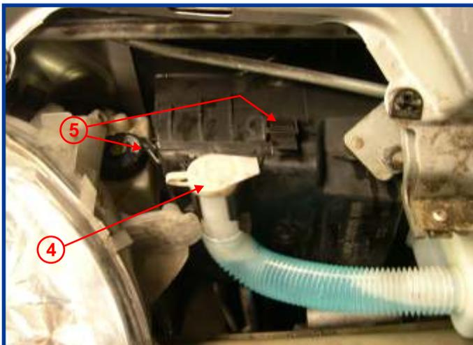
Soulever à présent la durite et le bouchon de remplissage de lave-glace (4) qui est fixé sur une glissière située sur le couvercle du boîtier filtrant. Ouvrir le boîtier filtrant en actionnant les fermoirs (5). Retirer ce couvercle.
