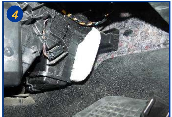
Extraire le filtre usagé en le déformant, l'ouverture du climatiseur étant plus petite.
