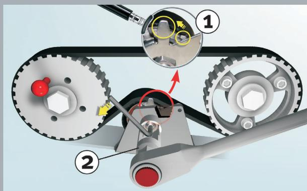
Image 1: Vue d'ensemble de l'entraînement et de la position du galet tendeur et de l'outil spécial
