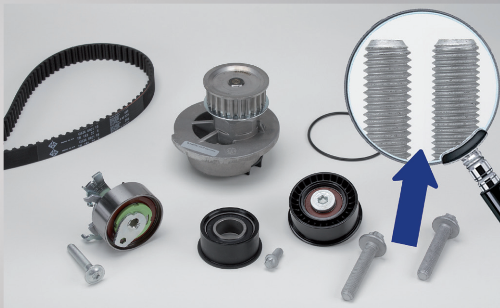
Photo 1: Le kit de distribution avec pompe à eau réf. 55327731 avec les deux types de vis de vilebrequin.
