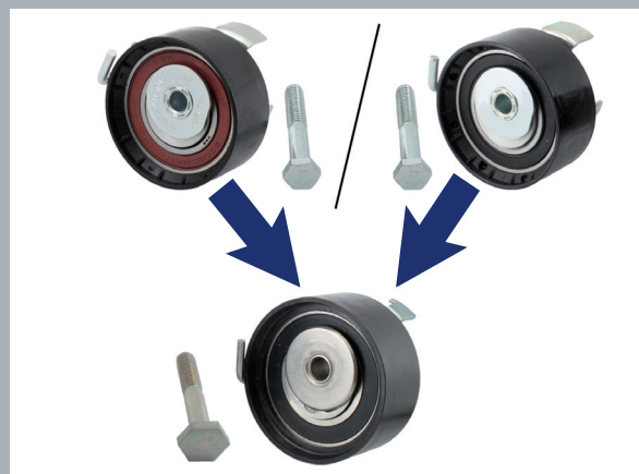
Photo 1: En haut, les anciens modèles équipés d'une étanchéité rouge ou noire / en bas, le nouveau modèle
