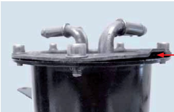
Figure 1 : Le couvercle du boîtier (KX 178) a été déformé parce qu'il a été mal ouvert et/ou fermé
