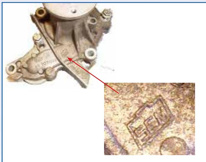
**La pompe de type SEM d'origine** peut être identifiée par la marque du fabricant sur le boîtier externe (voir l'image)
