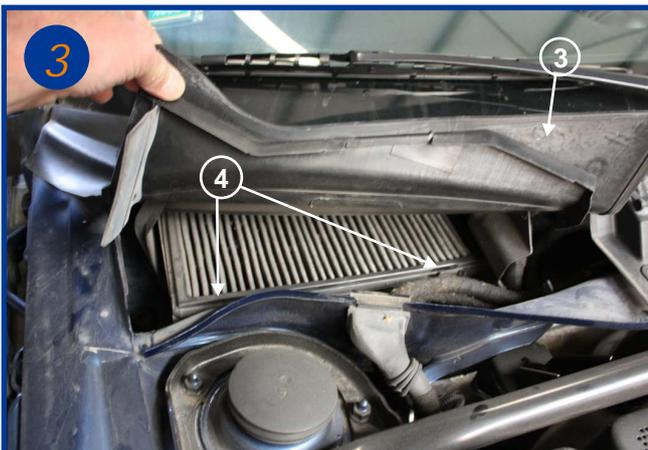
Soulever le carter souple et le maintenir ouvert (3), et basculer les 2 attaches plastiques (4) afin de retirer l'élément filtrant et son cadre.
