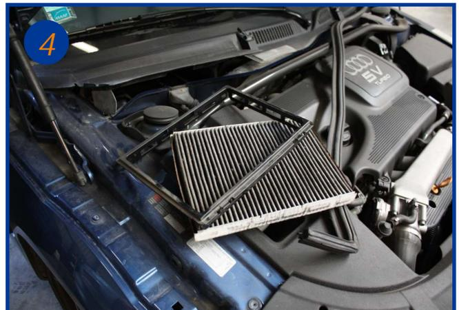
Retirer l'élément filtrant usagé de son cadre et remplacez le en imbriquant les 2 premiers plis dans les bordures du cadre. Le remontage s'effectue dans l'ordre inverse du démontage.
