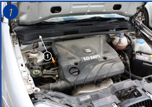
Le filtre d'habitacle est situé sous le capot moteur, côté passager sous la baie de pare-brise (1).
