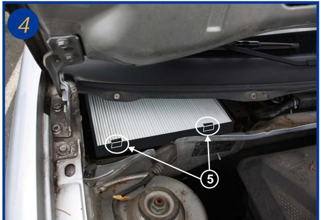
Basculer vers l'extérieur les 2 petites pattes (5) de maintien et procéder au remplacement du filtre. Le remontage s'effectue dans l'ordre inverse du démontage.
