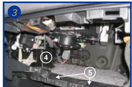
Déboîter la tubulure plastique (repère 4) en retirant le clips situé dessous puis le cache (repère 5) en retirant les 2 clips.
