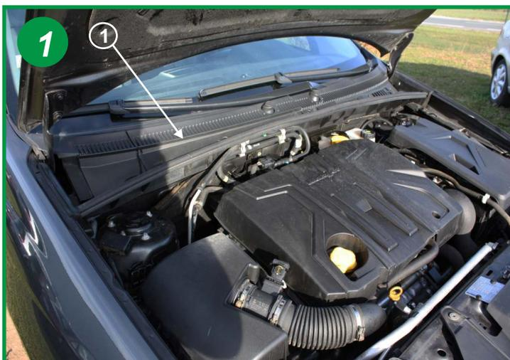
Le filtre d'habitacle est situé sous le capot moteur, coté passager devant la baie de pare-brise (1). Ouvrir le capot moteur.
