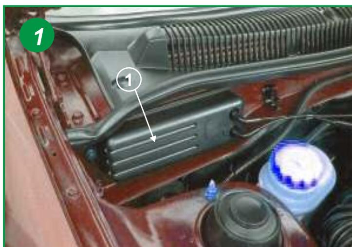
Le filtre d'habitacle est situé sous le capot moteur, côté passager sous la grille de ventilation (1).
