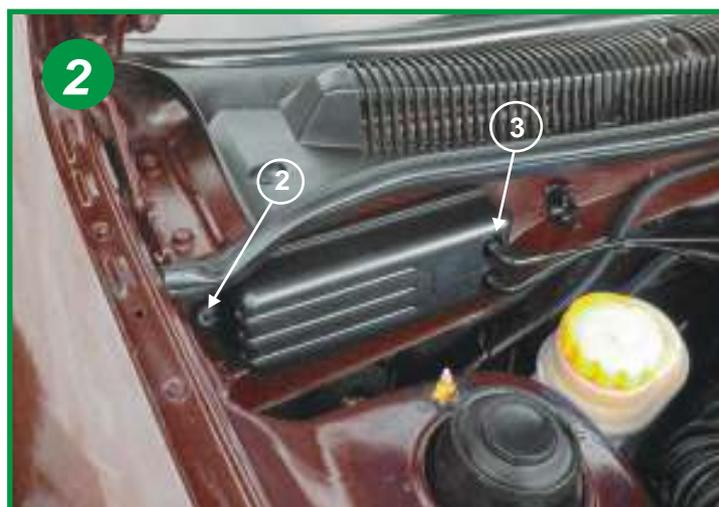
Dévisser la vis cruciforme (2) et ouvrir le boîtier sans débrancher la connectique (3).
