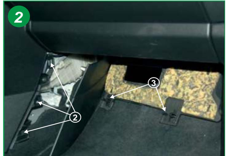
Dégrafer le flanc de la console centrale (2), puis le carter sous la boîte à gants (3). Les retirer totalement.
