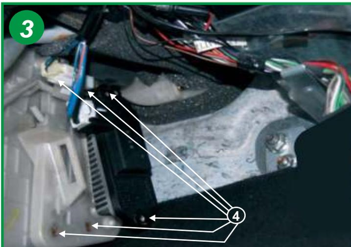
Dévisser les 6 vis cruciformes de fixation du couvercle du boîtier filtrant (4), retirer la trappe d'accès aux filtres.
