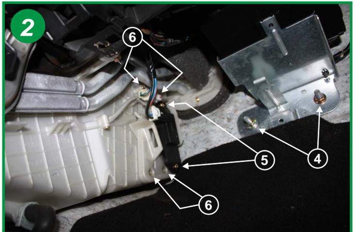
Dévisser les 2 écrous de 12 mm (4) et déplacer le support fusible vers la droite. Dévisser les 2 vis cruciformes (5), retirer le réchauffeur. Dévisser ensuite les 4 vis cruciformes (6) et retirer le couvercle du boîtier filtrant.
