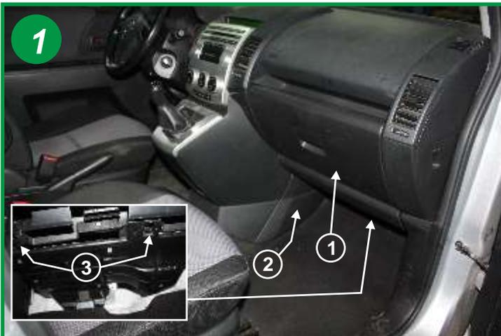
Les filtres d'habitacle au nombre de 2 sont situés côté passager sous la boîte à gants (1). Dégrafer le carter de la console centrale (2) en tirant dessus, puis le carter plastique sous la boîte à gants en manipulant les 2 fermoirs (3) (voir encadré).
