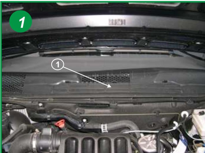
Le filtre habitacle est situé sous le capot moteur, devant la baie de pare-brise au centre (repère 1). Aucun outil n'est nécessaire pour son remplacement
