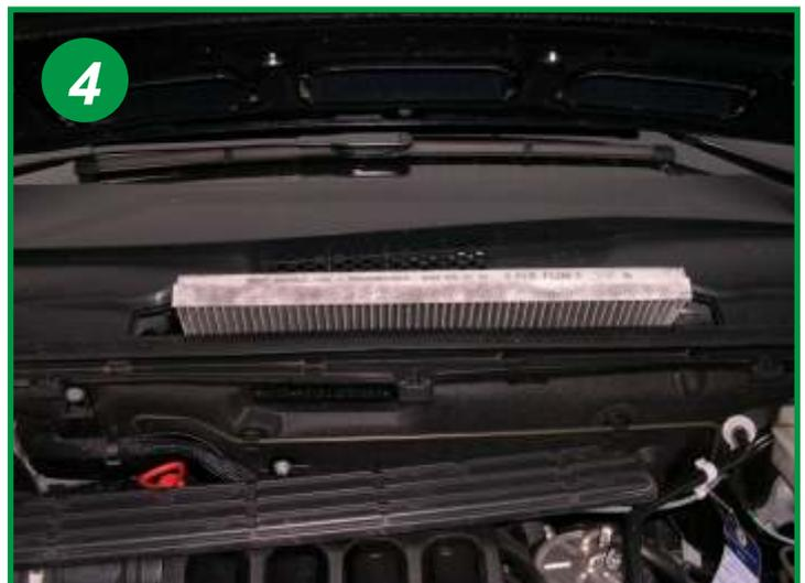
Extraire le filtre usagé et le remplacer. Le remontage s'effectue dans l'ordre inverse du démontage.
