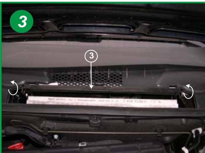
Basculer la trappe d'accès au filtre dans le sens des flèches (repère 3).
