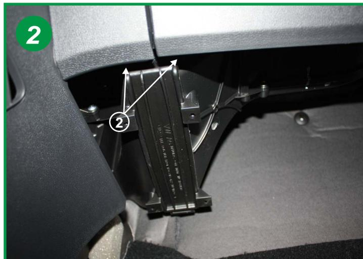
Retirer le couvercle du boîtier filtrant, pour cela accéder aux 2 pattes d'ouverture (2).
