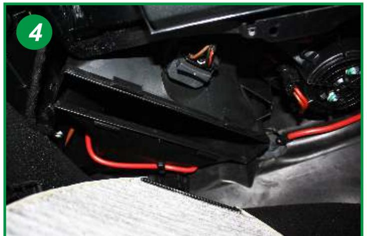
Procéder au remplacement de l'élément filtrant. Le remontage s'effectue dans l'ordre inverse du démontage.
