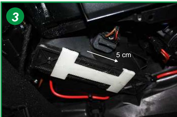
Le couvercle du boîtier filtrant fait partie intégrante de l'élément filtrant, faire coulisser d'environ 5cm vers la droite la pièce plastique blanche (3). Faire descendre l'élément filtrant usagé.
