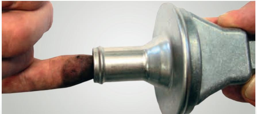
*Figure 1: Simple contrôle du clapet anti-retour*
