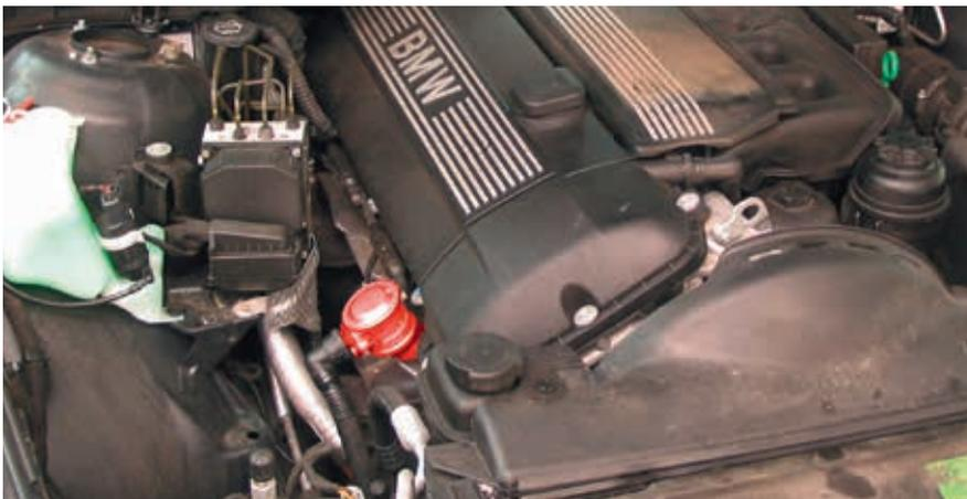
Les clapets d'air secondaire sont des composants du système d'air secondaire. Ils sont montés entre la pompe à air secondaire (1) et le collecteur d'échappement.
