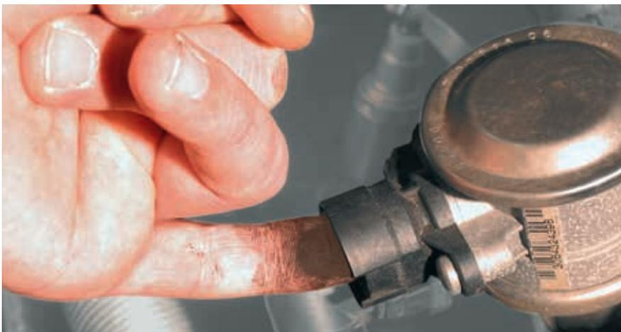
Rapide contrôle du clapet d'air secondaire dans la BMW 520i (mis en évidence)
