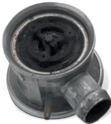
*Dégâts provoqués par une condensation des gaz d'échappement*
