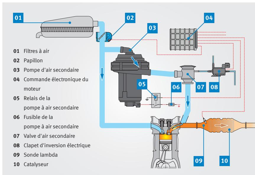
Principe de l'injection d'air secondaire (à commande pneumatique)
