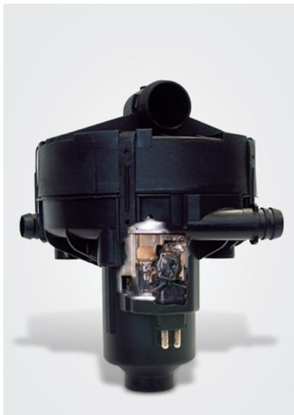
Vue de l'intérieur de la pompe d'air secondaire (en coupe) avec des traces de fusion
