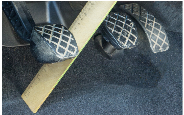
Photo 1 : Régler le jeu de la pédale après le remplacement de l'embrayage
